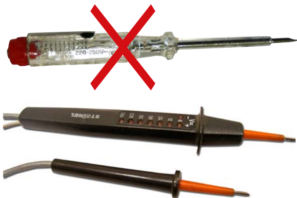
Abb. 22 Ein- und mehrpolige Phasenprüfer
