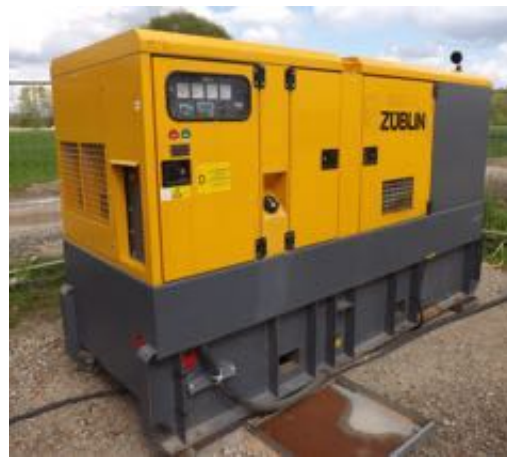
Abb. 1 und 2: Stromerzeuger von klein bis groß – ein Stromerzeuger muss sorgfältig ausgewählt werden. Als Beispiele ein moderner Inverter-Stromerzeuger Honda 20i für kleine Bau- und Montaggestellen und ein konventioneller Atlas QAS 150 zur Versorgung einer größeren Bahn-Baustelle inkl. Turmdrehkränen (Quelle: R. O. E. GmbH)
