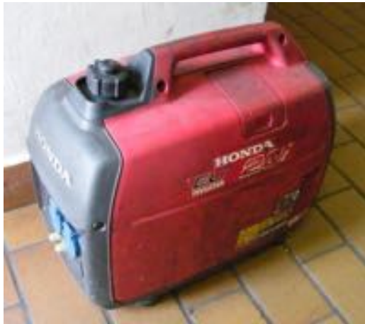
Abb. 1 und 2: Stromerzeuger von klein bis groß – ein Stromerzeuger muss sorgfältig ausgewählt werden. Als Beispiele ein moderner Inverter-Stromerzeuger Honda 20i für kleine Bau- und Montaggestellen und ein konventioneller Atlas QAS 150 zur Versorgung einer größeren Bahn-Baustelle inkl. Turmdrehkränen (Quelle: R. O. E. GmbH)
