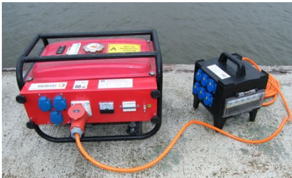
Abb. 5: Ein Stromerzeuger der Ausführung A mit einem Gummiwürfel. Dieser hat je Steckdose einen RCD. Im Prinzip also jetzt wie Ausführung B. Die weiteren Steckdosen am Stromerzeuger selbst dürfen nur mit PRCD oder Trenntrafo benutzt werden. (Quelle: R. O. E. GmbH)
