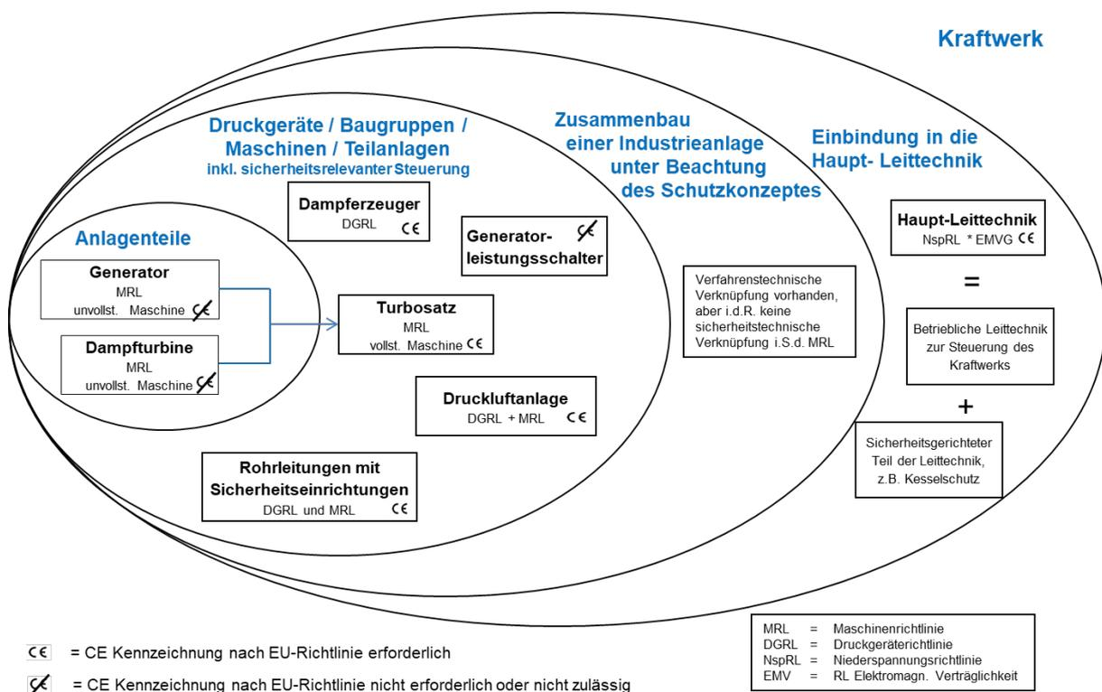
**Abb. 7** Zusammenbau einer Industrieanlage am Beispiel eines Kraftwerks
