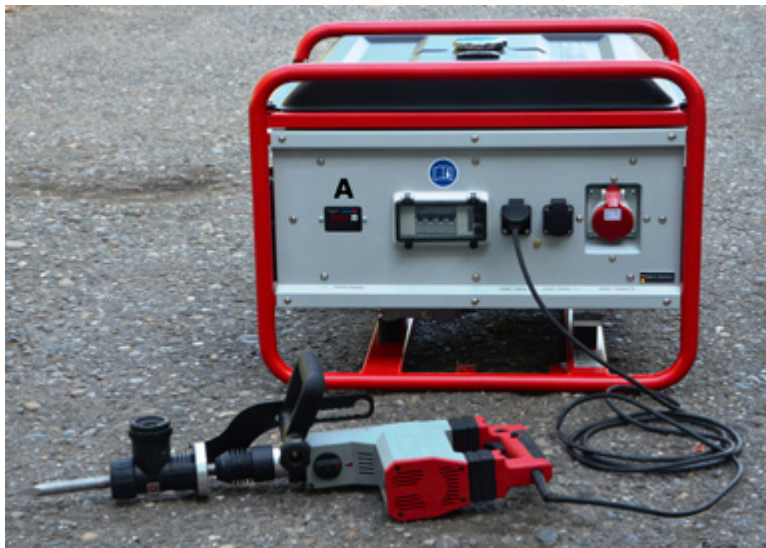
Abb. 20 Ein Betriebsmittel angeschlossen ohne weitere Schutzmaßnahme
