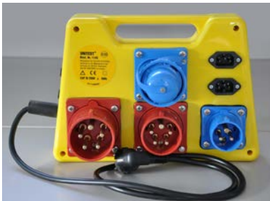
Abb. 7.1 Prüfadapter für Prüflinge mit Steckvorrichtungen, wie CEE-Norm 3~/400V/50 Hz oder 3~/200V/300 Hz o. Ä., die nicht direkt an ein Prüf-/Messgerät anschließbar sind.
