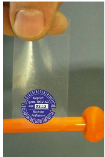
Abb. 3.21 Prüfbänderole zur Befestigung an der Anschlussleitung
